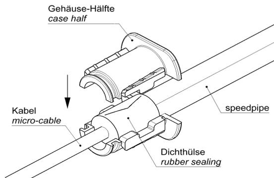
4) Die beiden Gehäuse-Hälften um die positionierten Dichthülse legen. Die Trennkanten des Dichtgummis und die der Gehäuse-Hälften versetzt montieren.
