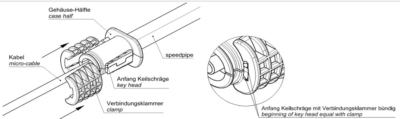
5) Verbindungsklammern über die beiden Gehäuse-Hälften schieben (auf Richtungskennzeichnung achten), bis der Anfang der Keilschräge mit der Verbindungsklammer bündig ist.
